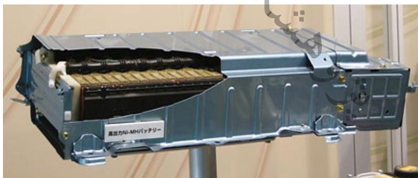
شکل ۷-۸- باتری قابل شارژ NiMH برای یک تویوتا پریوس (منبع ویکی‌پدیا، عکس اصلی از هاتسوکاری ۲ ).
