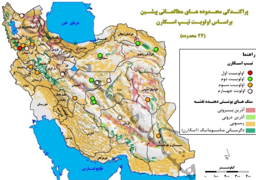
شکل ۸-۶- نقشه پراکنندگی ذخایر اسکارن با غنی‌شدگی احتمالی عناصر نادر خاکی در ایران (گزارش سازمان زمین‌شناسی و اکتشافات معدنی کشور، ۱۳۹۵).
