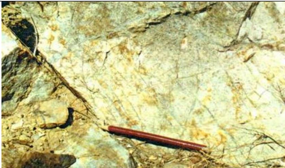
نگاره ۲۱- شبکه استوکورک رگه‌های سیلیسی در دگرسانی فلیک در کانسار مس پورفیری علی آباد یزد.
